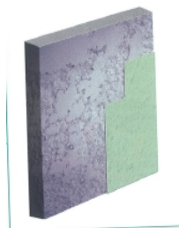
Ravalement simple enduit
