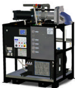
Figure 6.26 Pelletiseur de glace CO 2 (Cold Jet)
