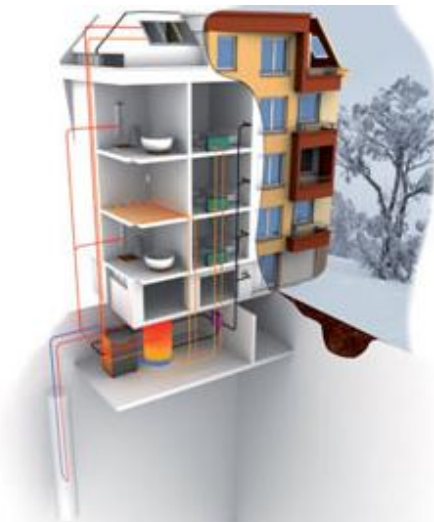
Schéma de principe d'une PAC géothermique à absorption gaz
