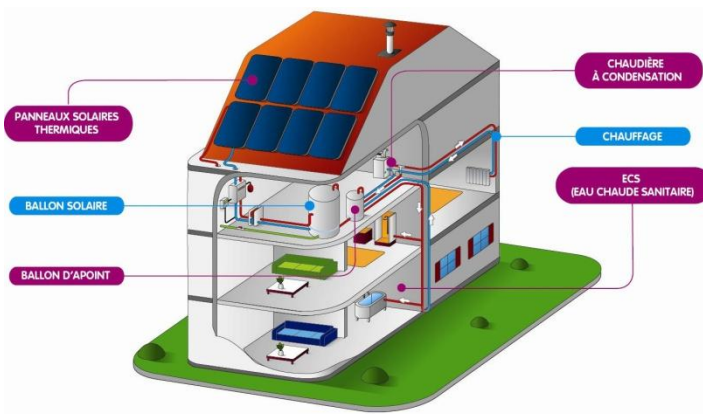
Schéma de principe d'un Chauffe-Eau Solaire Collectif
