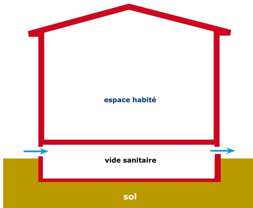
Le schéma ci-dessus représente le dispositif le plus simple, sans ventilateur : le vide sanitaire est ventilé naturellement, le plancher haut de ce vide étant étanche (béton en principe). Le vide sanitaire peut être remplacé par une cave, ventilée dans les mêmes conditions, avec des précautions particulières (voir plus haut) pour la porte d'accès.
